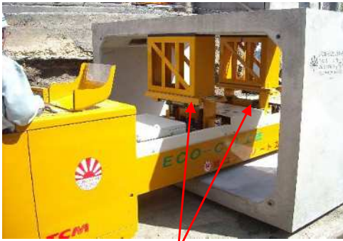
リフトアップ部
