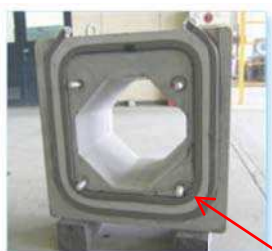
供試体の断面 (写真は 注入工法 ) 高弾性接着剤 (TBポンド)
