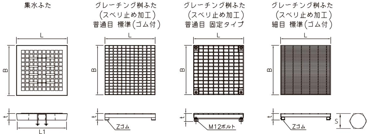
※グレーチングの固定用ボルトはM12です。S=10mmの六角棒レンチを使います。
