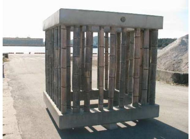
試験用として真竹を使用した竹魚礁を沈設し2年後に追跡調査を行った結果、竹の腐朽によって形状が著しく変化しており耐久面で劣る事が判明しました。平成19年から竹材を孟宗竹に変更しさらに節部分をくりぬき内部には鉄筋（D-10）を配置し流動コンクリートを充填した改良型の製品を開発しました。竹が腐朽し脱落しても内部のコンクリートで魚礁としての機能を維持する構造になっております。
