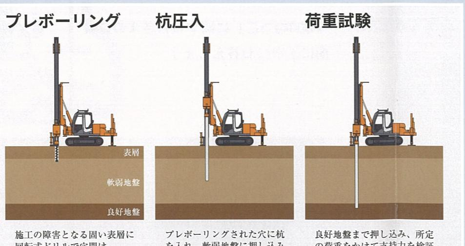
杭を良好地盤まで打ち込み、基礎と連携して建物の重さを支持
