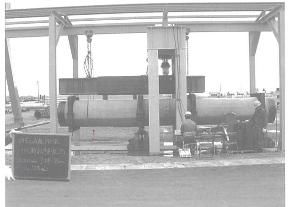
φ1000mm (I種) せん断実験の全景
